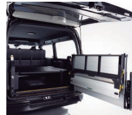
③横開きが可能で荷物の出し入れも楽々(SKYシリーズのみ)
