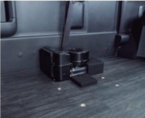
リアヒーターコンパートBOX
